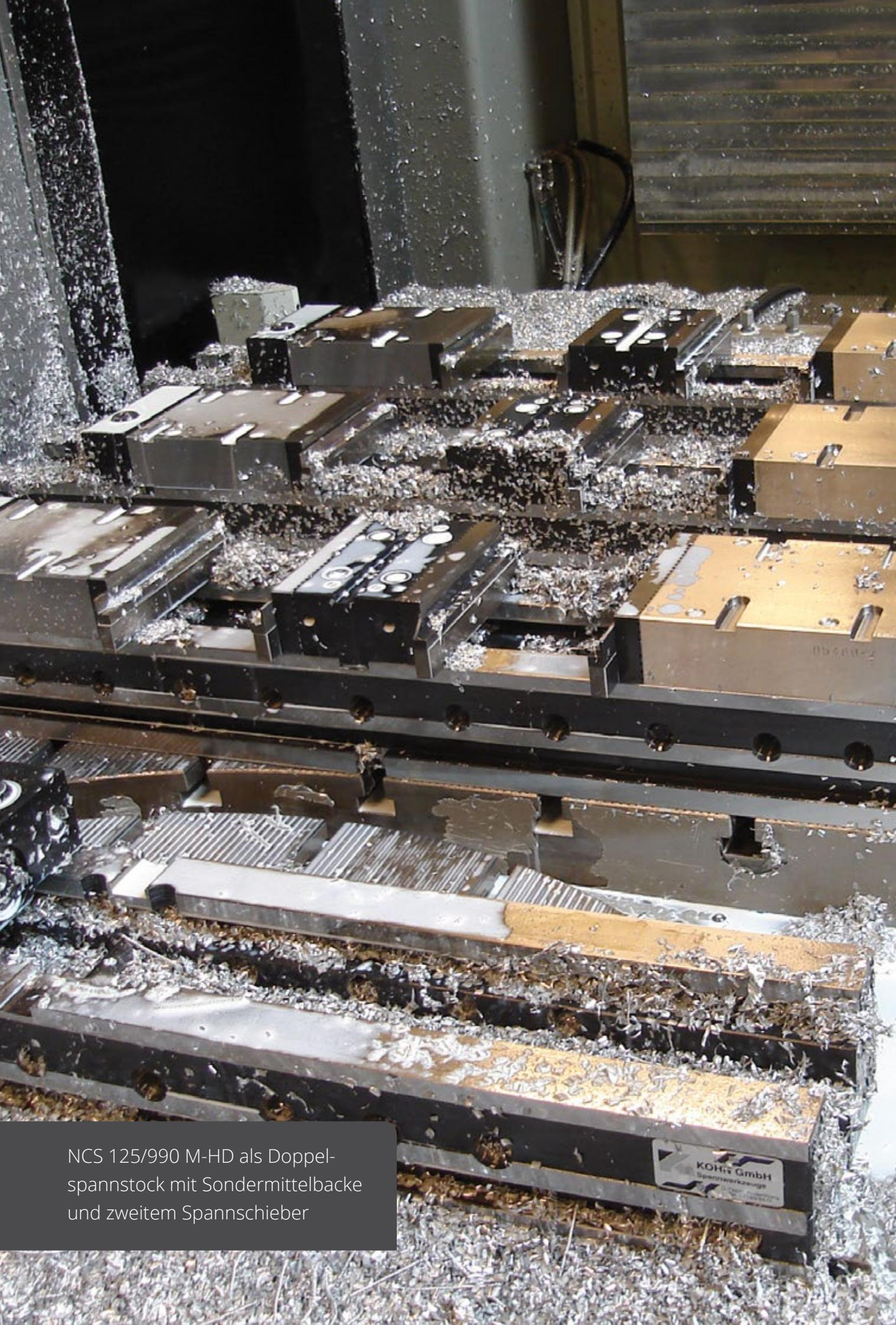
NCS 125/990 M-HD als Doppelspannstock mit Sondermittelbacke und zweitem Spanschieber
